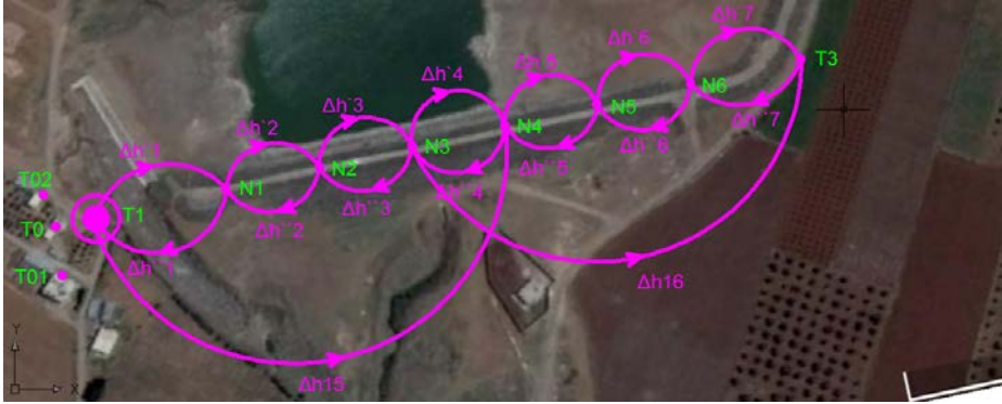
الشكل (10) شكل شبكة المراقبة الإرتفاعية المقترحة في سد طفس والحالة الثانية للقياسات
